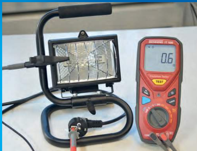
Widerstandsmessung zur Prüfung des Schutzleiters
