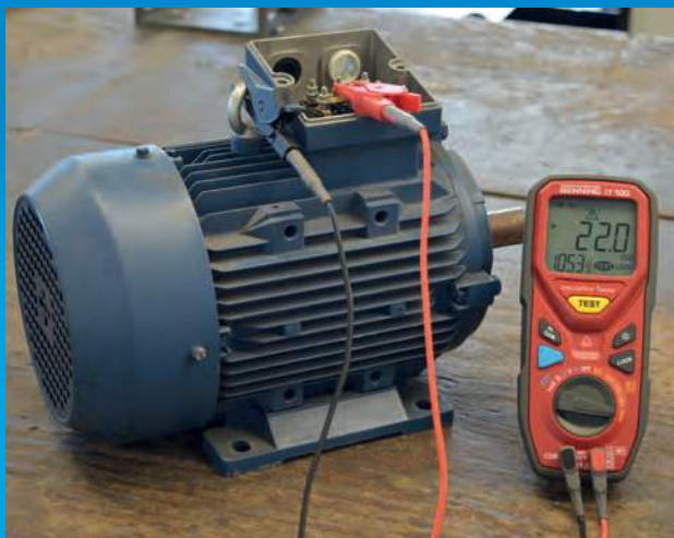
Messung des Isolationswiderstandes mit 1000 V
