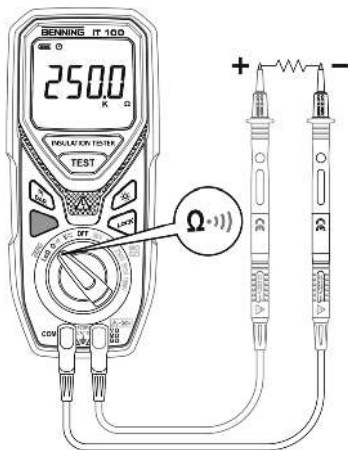
Abb.: Widerstandsmessung Figure: Resistance measurement Illustration : Mesure de résistance Afbeelding: Weerstandsmeting
